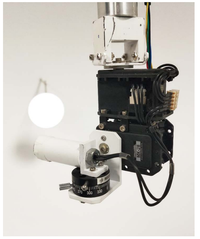
รูปที่ 2 ระบบสแกนทรงกลมรวมแสง ที่พัฒนาโดยกลุ่มงานแสงและสี
