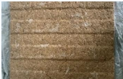
ต้นแบบจากโฟมรีไซเคิลที่เสริมแรงด้วยเส้นใยธรรมชาติ
